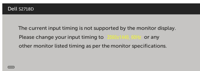
To znači da se monitor ne može sinkronizirati sa signalom koji prima s računala. Pogledajte [Monitor Specifications \(Tehnički podaci monitora\)](#) u vezi raspona horizontalne i vertikalne frekvencije koji se odnose na ovaj monitor. Preporučeni način rada je 2560 x 1440.
